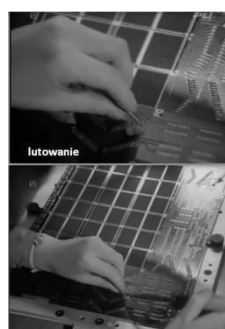
Fot. Dalszy ciąg procesu - lutowanie
